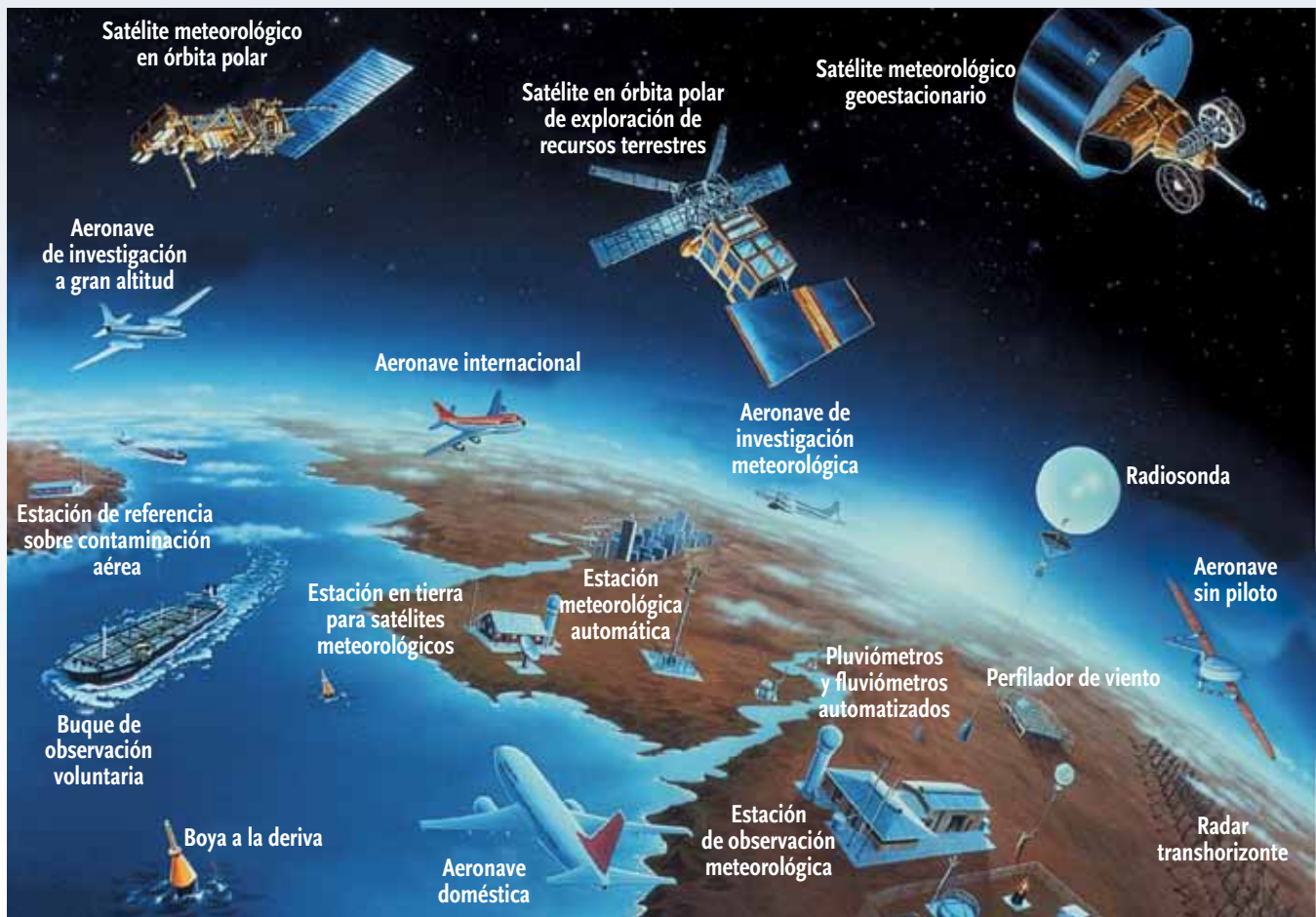
Ilustración de algunos de los múltiples sistemas de observación utilizados en la tierra, en el mar, en la atmósfera y desde el espacio para el monitoreo de variables meteorológicas, climáticas, hidrológicas y medioambientales conexas. La integración eficaz y efectiva es uno de los principales objetivos del WIGOS
